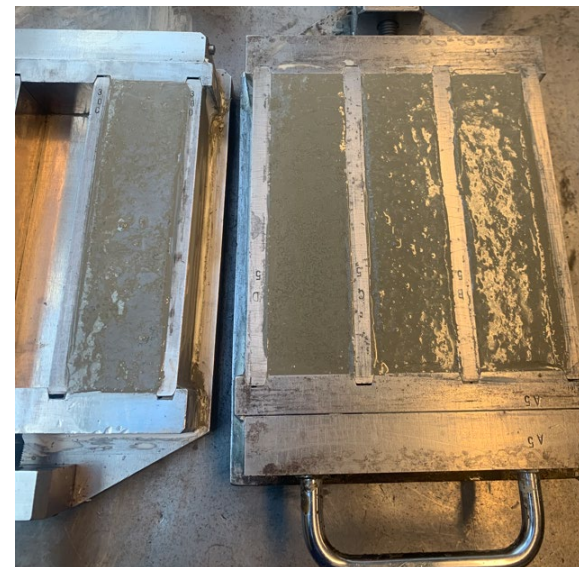
Bilde fra støp av prøver til utlekking
